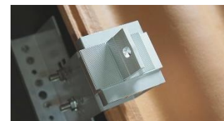
F. Alternativ 2 – Liggande layout. För liggande layout, montera adapter enligt bild. Drag åt insexskruv. Åtdragningsmoment 8-10 Nm
