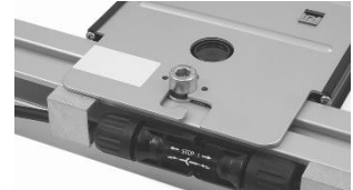
C. Skjut intill optimerare i skruvsats och drag åt. Åtdragningsmoment 12 Nm
