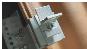
E. Alternativ 1 – Stående layout. För stående layout, montera adapter enligt bild. Drag åt insexskruv. Åtdragningsmoment 8-10 Nm
