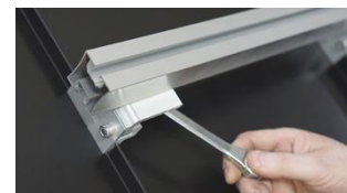
C. Drag åt skena med M10 flänsnuttar. Åtdragningsmoment 20-25 Nm
