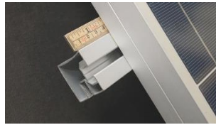
B. Skena behöver sticka ut minst 40 mm.
