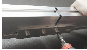
B. Drag åt profilförbindare med 4st. korta insexskruv.
