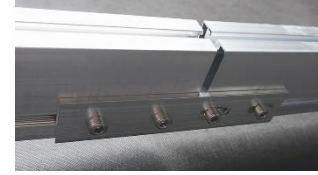
C. Skapa med fördel en liten glipa mellan skenor, som tillåter termisk utvidgning.
