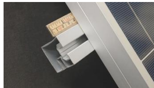
B. Skena behöver sticka ut minst 40 mm.
