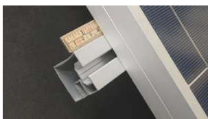
B. Skena behöver sticka ut minst 40 mm.
