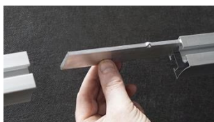
A. För i profilförbindare i skena.
