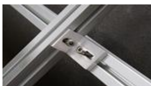
B. Montera ihop korsförband med förbindningsvinkel. Använd kort M8 insexskruv. Åtdragningsmoment 12 Nm
