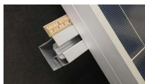
B. Skena behöver sticka ut minst 40 mm.
