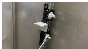
A. Notera falsomslag på takplåt. Placera klämma på önskad fals och drag åt. Åtdragningsmoment 40 Nm
