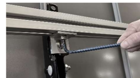
C. Skruva fast skena med kort insexskruv. Åtdragningsmoment 12 Nm
