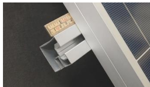
B. Skena behöver sticka ut minst 40 mm.
