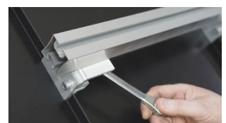
C. Drag åt skena med M10 flänsmutter Åtdragningsmoment 20-25 Nm
