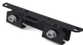
B. Flytta klämma till önskad position på fals och drag åt. Åtdragningsmoment 20-25 Nm
