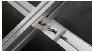
B. Montera ihop korsförband skena 110116 och skena 110117 med förbindningsvinkel. Använd kort M8 insexskruv. Åtdragningsmoment 12 Nm
