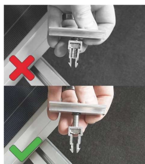
Insexskruv på mittklämma får EJ vara för långt gängad genom clips.
