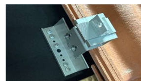
F. Alternativ 2 – Liggande layout. För liggande layout, montera adapter enligt bild. Drag åt insexskruv. Åtdragningsmoment 12 Nm
