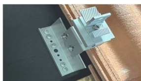
E. Alternativ 1 – Stående layout. För stående layout, montera adapter enligt bild. Drag åt insexskruv. Åtdragningsmoment 12 Nm
