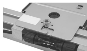
C. Skjut intill optimerare i skruvsats och drag åt. Åtdragningsmoment 12 Nm
