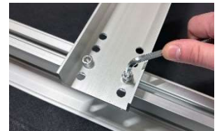
I. Skruva fast brygga med 2 insexskruv och spårnuttar. Åtdragningsmoment 12 Nm
