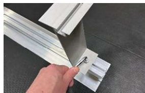
B. Vrid i en spårnutt i skenans bakkant, Lätt åtdragning av insexskruv.
