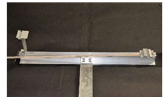
C. Avstånd mellan fram och bakben. Anpassas efter ditt panelmått.
