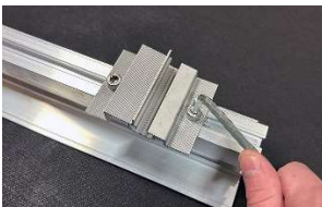
A. Placera framben jäms med skenans ända, skruva fast framben med 2 insexskruv och spårnuttar. Åtdragningsmoment 12 Nm
