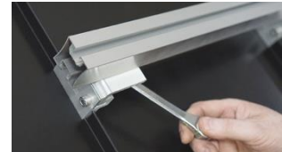
C. Drag åt skena med M10 flänsmutter 140622. Åtdragningsmoment 25-27 Nm
