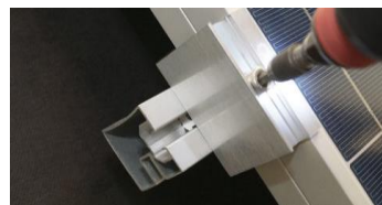
L. Skjut intill ändklämma mot solcellspanel och drag åt. Rek åtdragningsmoment 8-10 Nm
