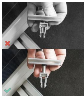
Insexskruv på mittklämma får EJ vara för långt gängad genom clips
